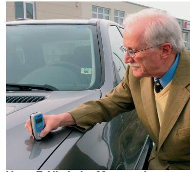
Hans F. Nix beim Messen der Lackdicke einer Autokarosserie mit einem neuentwickelten Surfex® easy FN
